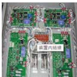
下水管あるいは通信ケーブルを敷設際、管路ずれないようにレーザーで位置を高精度に計測するユニット
